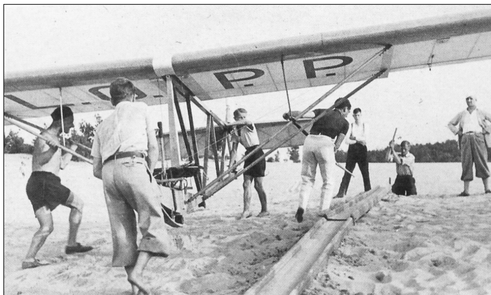
Fot. 1. Start szybowca przez naciąganie linami gumowymi, Bezmiechowa, około 1935 r., za: „Sport lotniczy” s. 37
